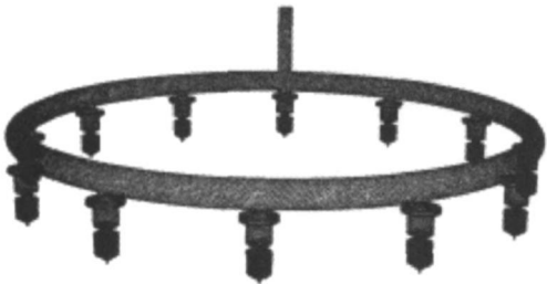
图 3 喷油环网格模型 Fig. 3 Grid model of nozzle loop
